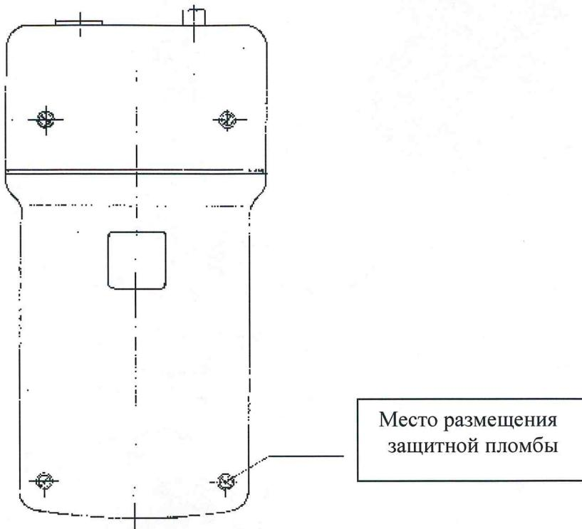
Рисунок 2 – Схема пломбировки от несанкционированного доступа
